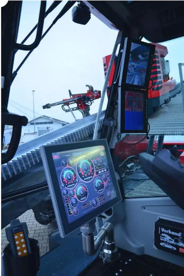
Neu entwickeltes intuitives Bedienkonzept: Über zwei Joysticks können alle Hauptfunktionen angesteuert werden. Das große 19“-Touch-Panel bildet auf einen Blick alle relevanten Bohrparameter sowie den Status der Anlage ab. | Foto: Max Streicher
