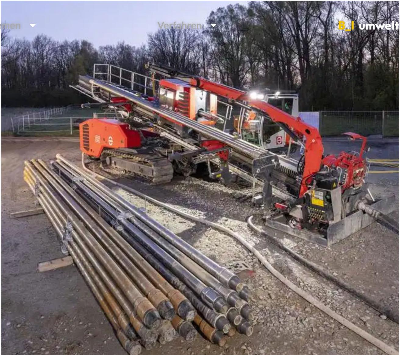
Die neue vollelektrische Horizontalbohranlage von Max Streicher ist um ein Vielfaches leiser als ihre Vorgänger und senkt die CO<sub>2</sub>-Emissionen deutlich. | Foto: Max Streicher
