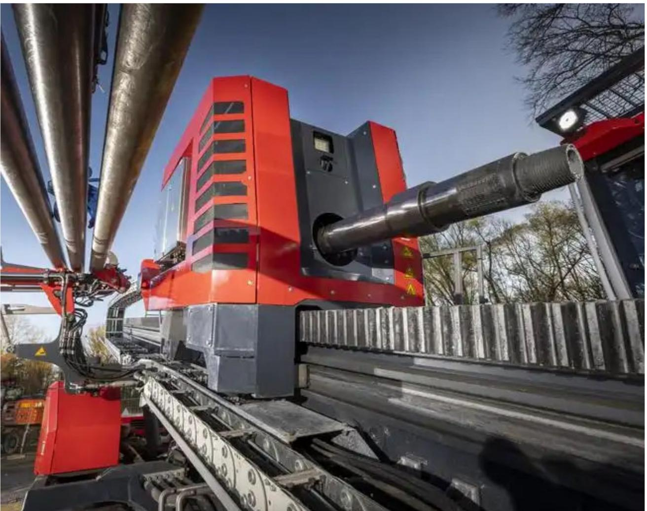
Die E-Anlage verfügt über eine Zug- und Druckkraft von 80 Tonnen und ist für Range-2-Bohrgestänge konzipiert (9,5 m). | Foto: Max Streicher
