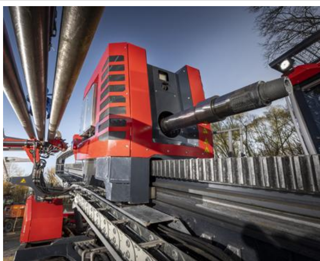
Der Antrieb der HDD80-E ist von Grund auf elektrisch ausgelegt. Von der Rotation über den Vorschub bis hin zu Spülpumpe und Fahrwerk
